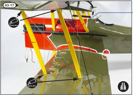
机翼支架安装到上下机翼之间,插入机翼上的预留孔,连接处用环氧胶粘固。安装支架时注意调整方向。
